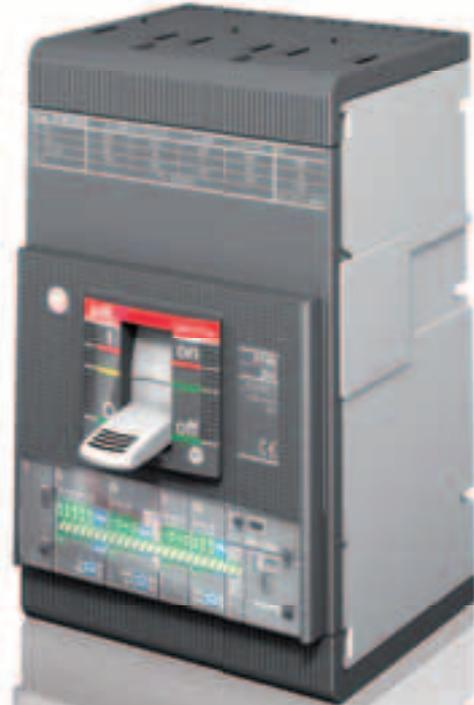
En las aplicaciones navales, por ejemplo, se requieren elevados poderes de corte a 690V. Los interruptores SACE Tmax XT2 y XT4 alcanzan los poderes de corte más elevados del mercado. En particular el XT2 alcanza un valor de 20kA@690V, 150kA@415V mientras que el XT4 alcanza los 90kA@690V para 160A, 150kA@415V para 250A.
