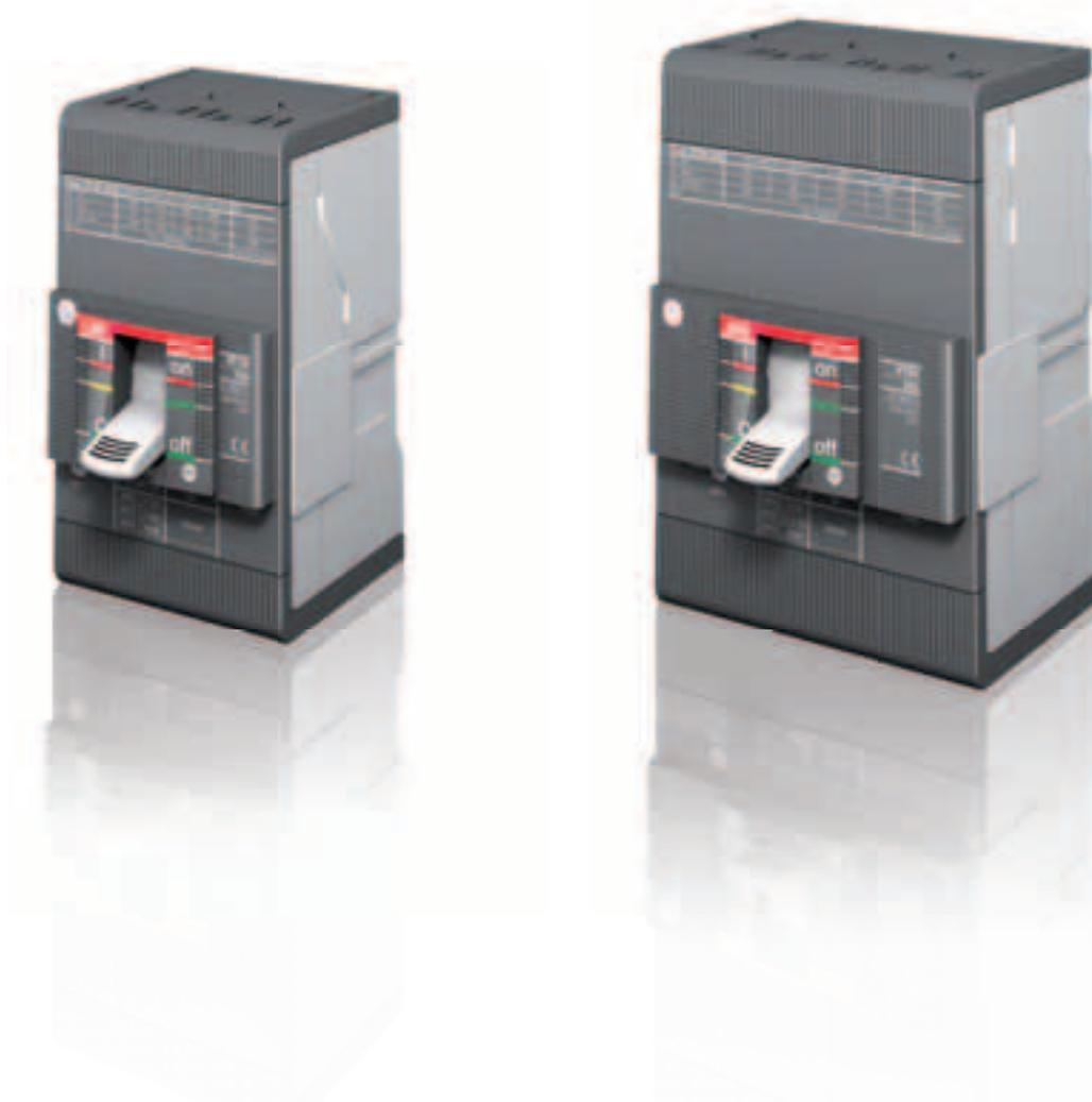
SACE Tmax XT1 y XT3 se emplean en instalaciones que efectúan grandes suministros eléctricos, hospitales y todas aquellas aplicaciones en el sector de los servicios que necesitan sobre todo una gran fiabilidad. Los interruptores SACE Tmax XT3 se pueden emplear para la protección de motores, para la protección de generadores y como interruptores no automáticos maniobra-seccionadores.
